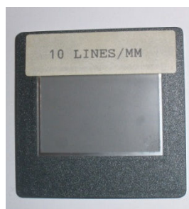
Εργαστηριακό οπτικό φράγμα με 10 χαραγές / mm
